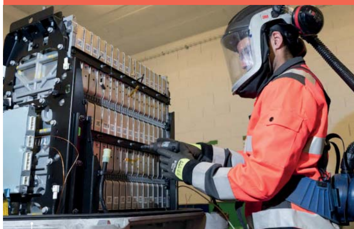
Démantèlement d'une batterie - ©Veolia
